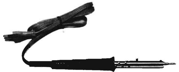
Fig. 3 - Modello di saldatore, dotato di presa di massa, consigliato ai radioriparatori dilettanti.
